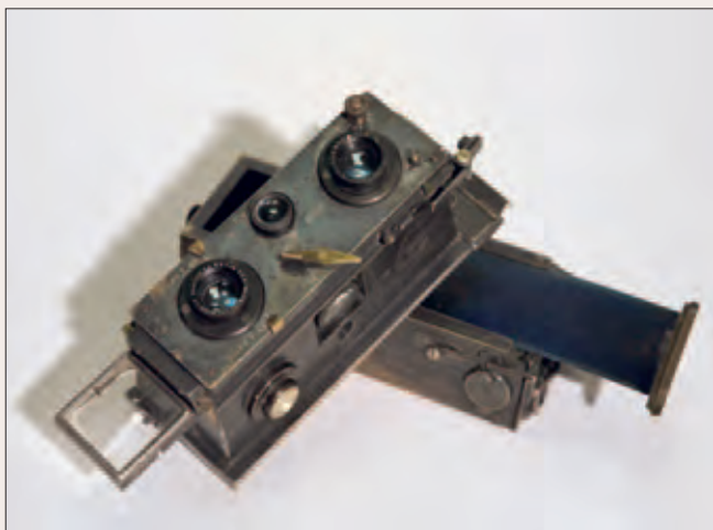
Рис. 2. Ручной стереоскопический фотоаппарат «Вераскоп» фирмы «Ришар» (Париж) для пластинок формата 4,5 × 10,7 см. Объективы с большим относительным отверстием F: 4,5 и затвором Хрономос. Модель 1908 г. Музей истории фотографии (Санкт-Петербург). Фото Д. С. Шнеерсона. С любезного разрешения музея
